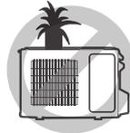
Zones où l'entrée et la sortie d'air peuvent être obstruées.
