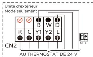
24 V ne doit jamais être connecté à S1 - S2. Tout le câblage doit être conforme aux scénarios ci-dessus.
