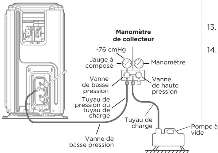
6. Faire fonctionner sous vide pendant au moins 15 minutes, ou jusqu'à ce que le compteur de composés indique  $-76\text{cmHg}(-10^5\text{Pa})$  ou 500 microns.
