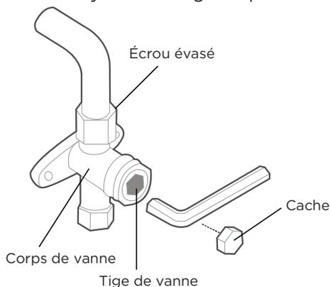
13. À l'aide d'une clé hexagonale, ouvrir complètement les vannes de haute pression et de basse pression.
