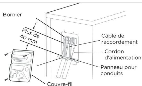
Veuillez sélectionner le trou de passage approprié en fonction du diamètre du fil.
