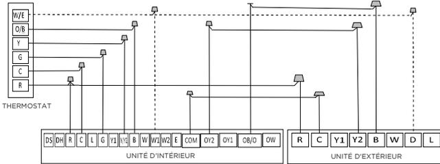
S4-4 Activé par défaut, W1 et W2 en court-circuit pour le fonctionnement single stage Aux heat (chaleur auxiliaire en une seule étape). Éteindre pour séparer les étapes.
